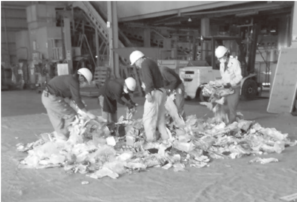
手作業で適切物と不適物に選別を行い、不適物を分類ごとに区分
