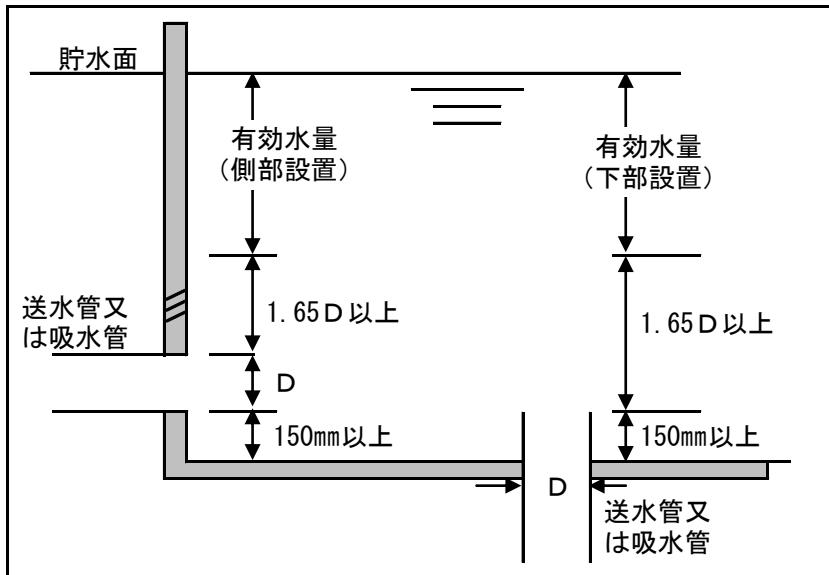
(イ) 前(ア)によるほか、吸水管等に渦流防止板を設けた場合の有効水量は、次によること。この場合において、渦流防止板は $0.36\text{m}^2$ 又は $D$ に $5\text{m}$ を乗じて得られる面積のいずれか大なる面積以上の広さを有するものとする。
