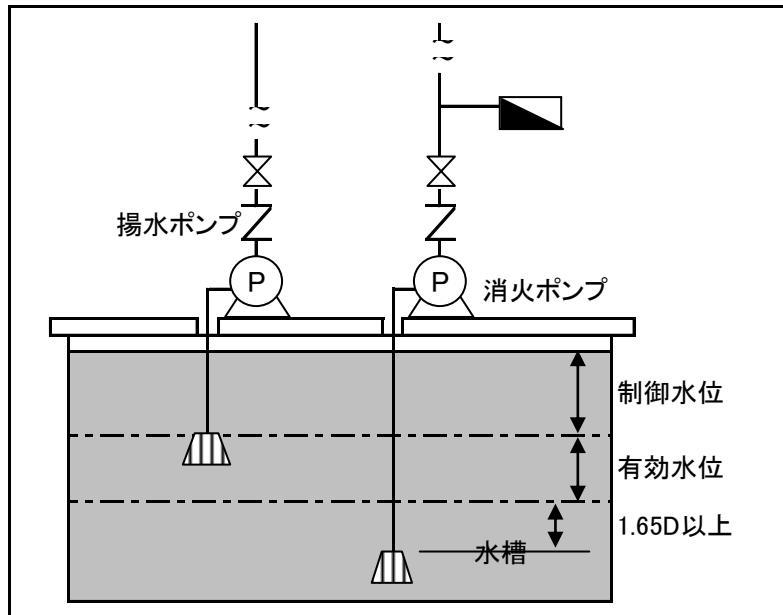
エ 加圧送水装置に水中ポンプ等を用いる場合は、最低運転水位以上の水位を有効水量とすること。
