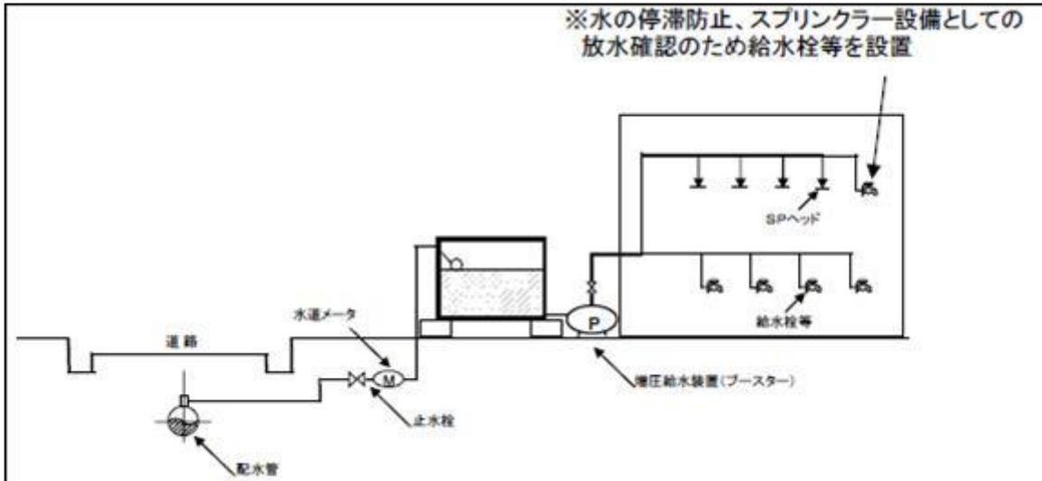
《直結・受水槽補助水槽併用式の例》
