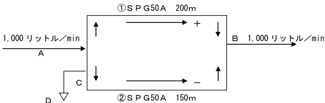
(1) 配管①及び②に流れる仮想流量（任意の値を設定）をそれぞれ500リットル/minと想定し、配管の摩擦損失水頭を摩擦損失基準により求める。
