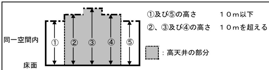
(ウ) 天井に開閉する部分がある場合は、当該天井が閉鎖された状態における床面からの高さとする。
